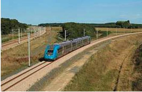
Loire, parcourable à 200 Km/h par des TER classiques, en fait des rames électriques Z 21700, version des Z 21500 équipées du cab-signal pour circuler sur les LGV. C'est, ou plutôt, c'était une première en France : faire circuler des automotrices TER, donc du matériel régional classique, sur des lignes à grande vitesse à 200 Km/h. Le but : créer des liaisons Nantes-Rennes desservant Angers et Laval, chose jusque-là impossible
